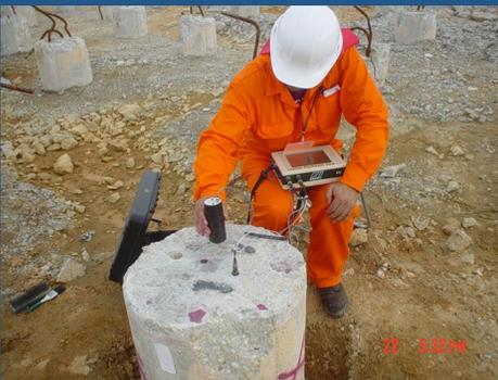
Acelerómetro de alta sensibilidad
