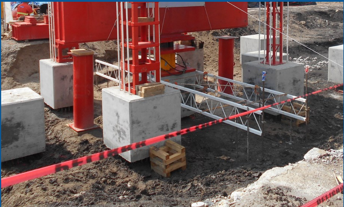
Vista de datos de reacción y cabezal de pila de prueba
