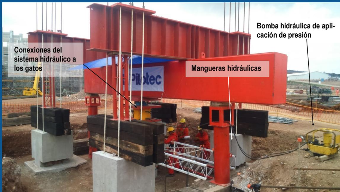
Vista de la bomba hidráulica para la aplicación de la carga y del sistema de conexión bomba-gatos
