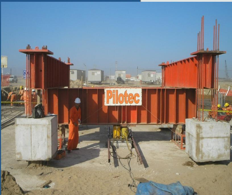
Las pruebas se realizaron bajo los procedimientos de las normas ASTM para prueba de Carga de compresión axial D 1143 *Standard test method for piles under static axial compressive load*. Carga de tensión axial D 3689 *Standard test method of testing individual piles under static axial tensile load*. Y carga lateral D 3966 *Standard test method of testing piles under lateral loads*.
