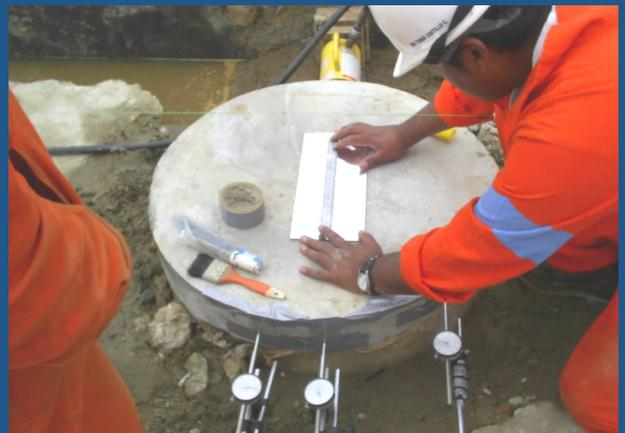
Instrumentación de cabezal de pila
