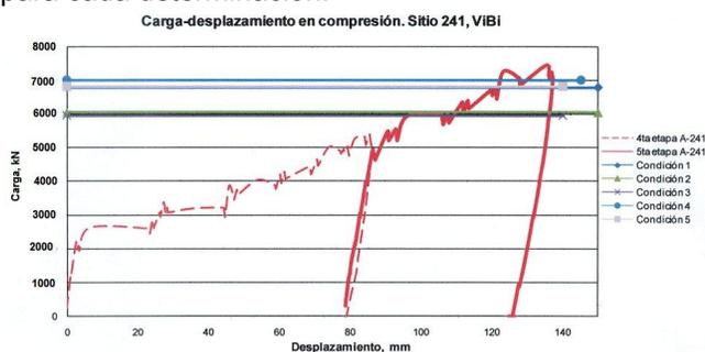
Figura 6. Comparación entre el comportamiento medido de la pila de prueba, y las diferentes estimaciones teóricas y empíricas de carga última.
