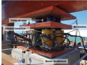
**Figura 3.** Sistema de cilindros hidráulicos y celdas de carga
