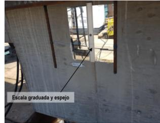
**Figura 6.** Sistema de medición por medio de escala graduada y espejo
