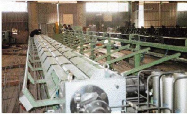
Fig 5. Planta de centrifugado de pilotes (Koami, 1999)
