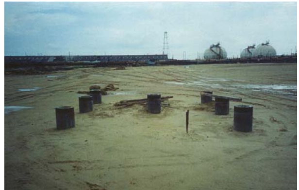
Fig 13. Configuración del pilote de prueba y los de reacción, al inicio de los ensayos
