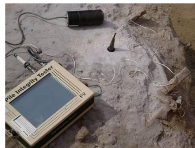
Figura 2, Equipo de pruebas de integridad, acelerómetro, martillo y colector de datos.
