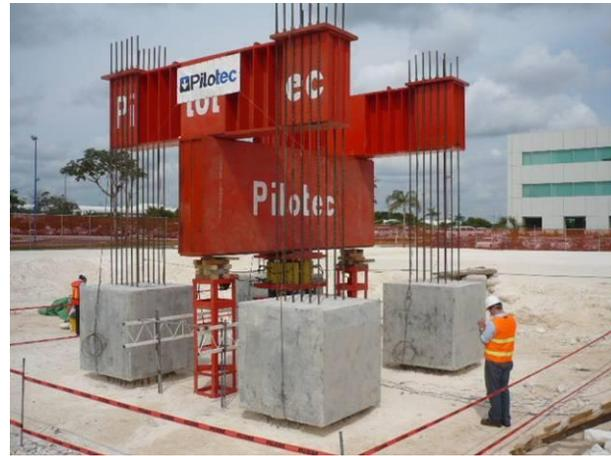
Figura 6.10. Sistema de carga para prueba de compresión axial
