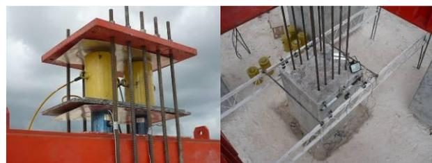
Figura 6.9. Instrumentación durante la prueba de tensión
