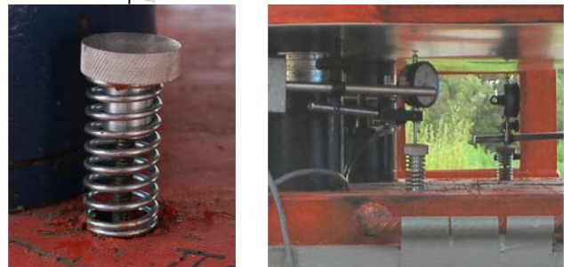
Figura 5 Esquema y vistas de testigos de deformación a profundidad
