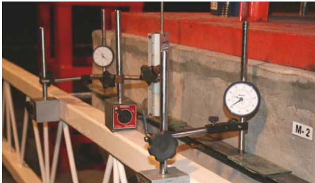
Figura 4 Instrumentos de medición de los desplazamientos verticales en el cabezal
