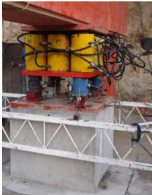
Figura 6. Instrumentación y elementos de carga en la pila de prueba
