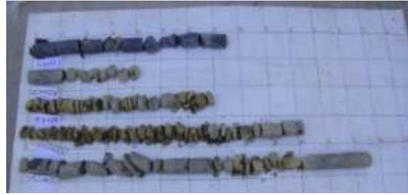
Figura 2. Núcleos de roca deficientemente recuperados
