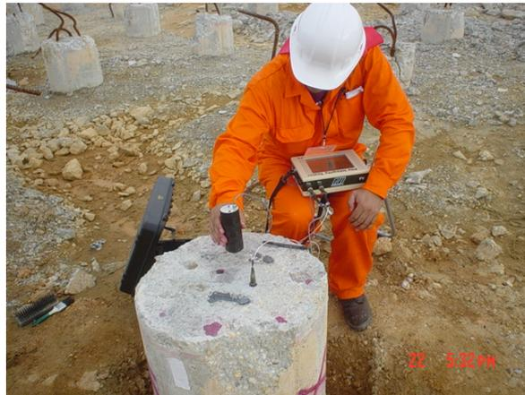
Fig 21, Prueba de integridad en pila
