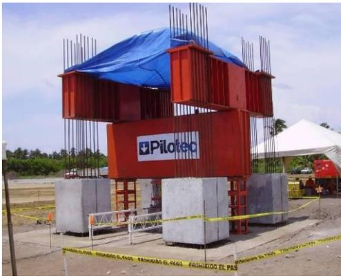
Fig. 5. Arreglo de pruebas de carga a compresión
