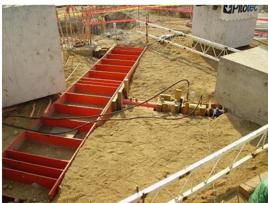
Fig. 12, Arreglo general de prueba lateral
