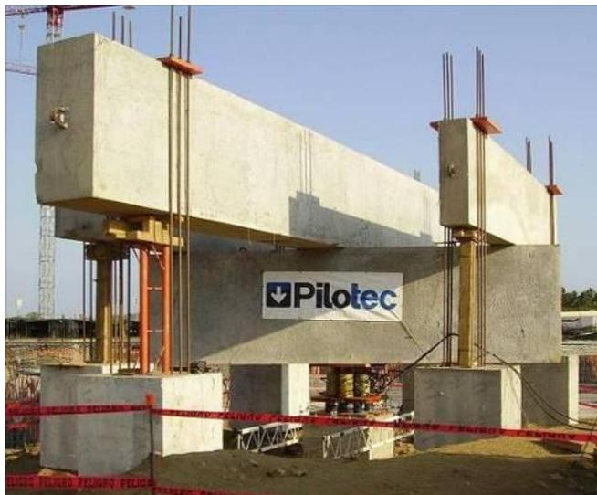
Fig. 10, Sistema de reacción para las pruebas de compresión axial
