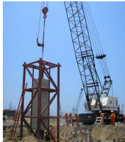
Figura 7 Vista del sistema de carga para las pruebas de carga dinámica en pilas
