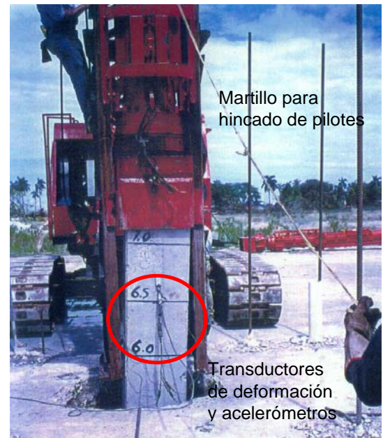
Figura 12. Arreglo general del sistema de pruebas de carga dinámica.
