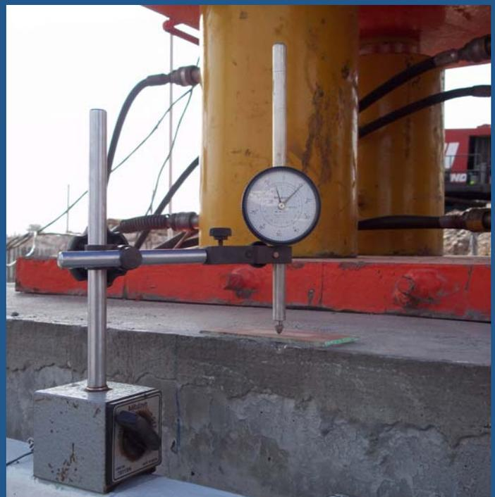
Instrumentación en cabezal
