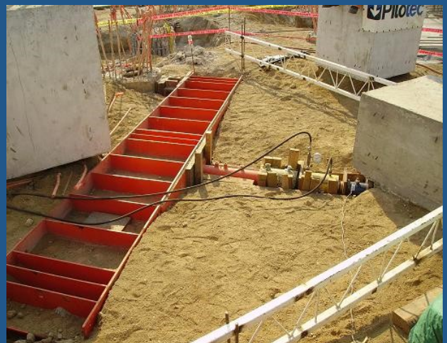
Prueba de carga lateral
