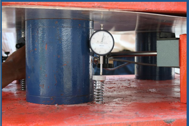
Instrumentación de cabezal de pila: celda de carga, tell tale y deformímetros
