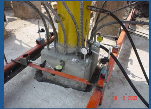
Cabeza del pilote con instrumentación para medir deformaciones.
