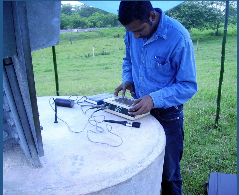
Ejecución de una prueba de integridad
